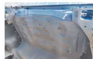
La parte inferior de la cabina está pulverizada con material resistente a los golpes de piedra, con un mejor efecto de resistencia a la corrosión y a los golpes de piedra
