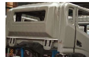
Electroforesis integral de la cabina, con una resistencia excelente a la corrosión
